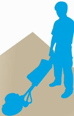
5~10分程後、ポリッシャーに剥離用の黒パッド等を付けて丁寧に回して下さい。乾燥しない様に注意し必要に応じてタンクに水を入れ、出しながら洗って下さい。
