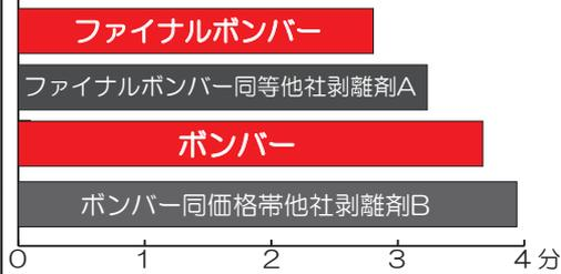
※高濃度樹脂ワックス5層塗布テストピースで6倍希釈比較。白パッドで擦り、残存皮膜の有無で時間判定した結果。
